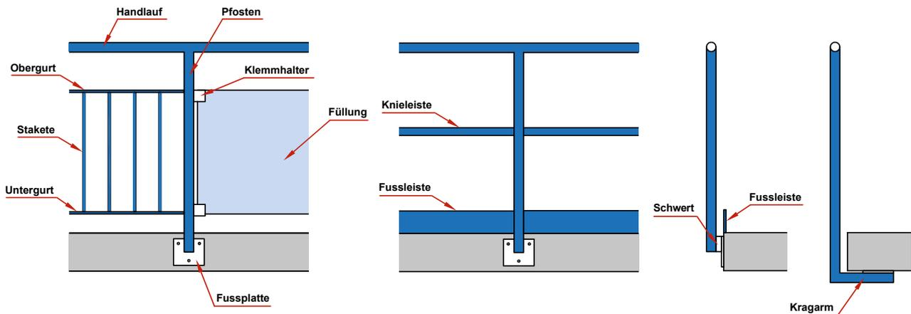
Abbildung 1: Bauteile eines Geländers
